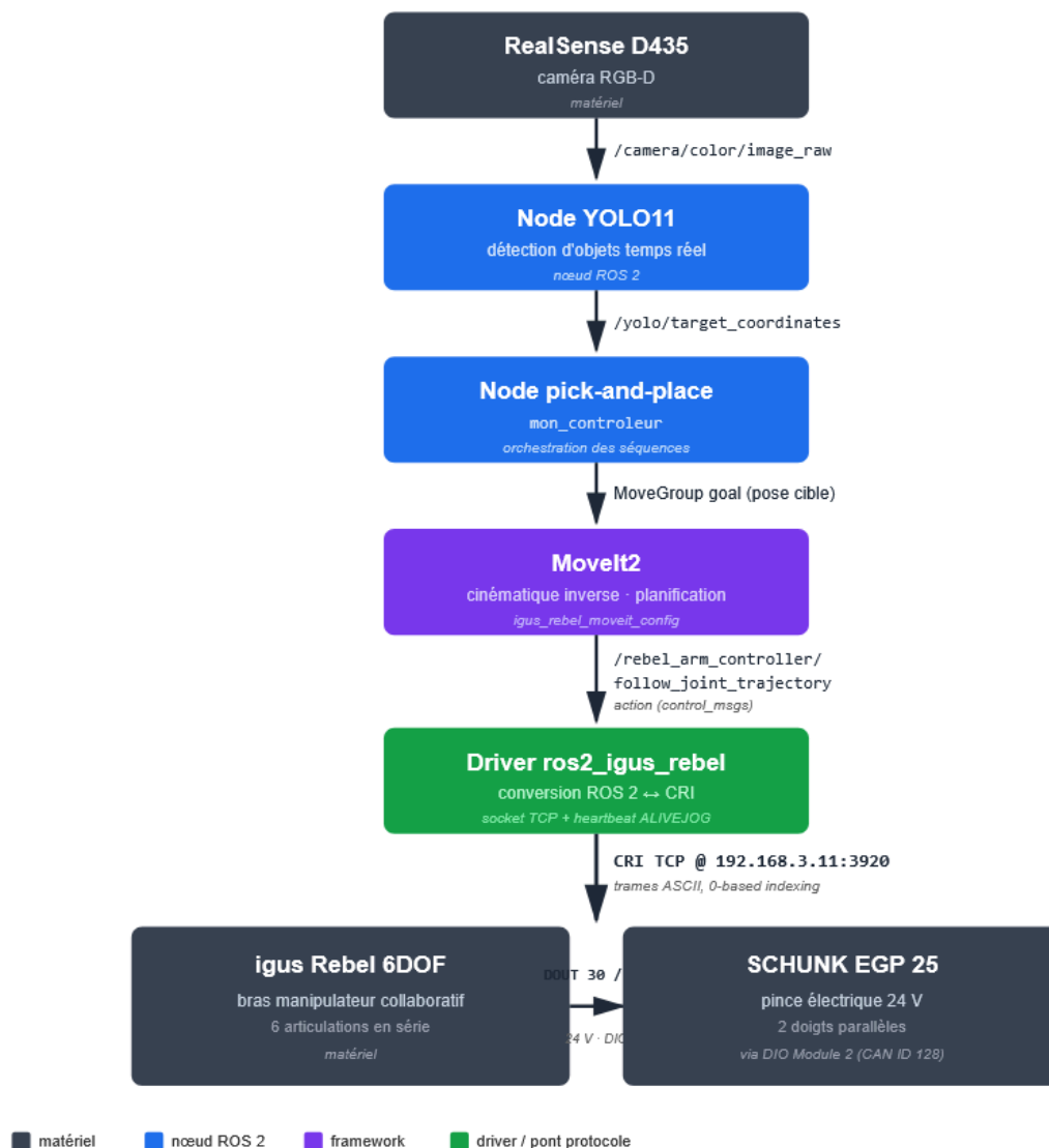
Figure 3.1 : Schéma de l'architecture globale
