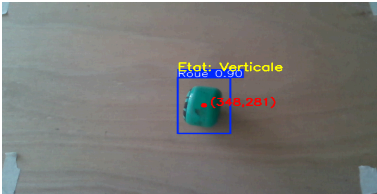
Figure 4.1.2 : Détection d'une roulette en position verticale.
